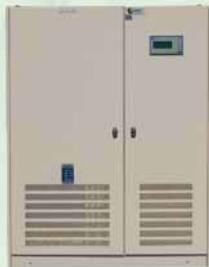
CM2008 — это новая серия ИБП с однофазным выходом номинальной мощностью от 5 кВА до 120 кВА. Напряжение батареи, значения которого определяются в диапазоне от 110 до 220 В постоянного тока, позволяет работать батареям в оптимальном режиме и тем самым снижает издержки. Как и инженерные системы, серия CM2008 обеспечивает доступ к оборудованию с передней панели и позволяет внедрять индивидуальные разработки в соответствии с пожеланиями заказчика.
